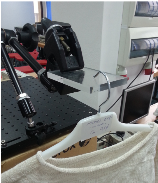
Fig. 6. Izolarea electrostatică a ansamblului mostră-umeraș
