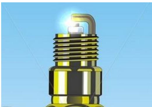
Fig. 1. Descarcare electrica de tip scanteie [10].
