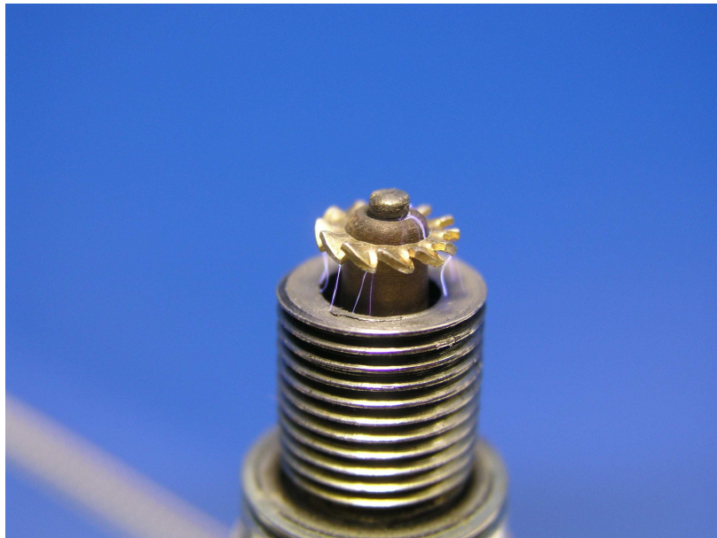
Figura 3 – Bujie cu dubla descarcare, dimensiuni clasice, functionand la presiune atmosferica
