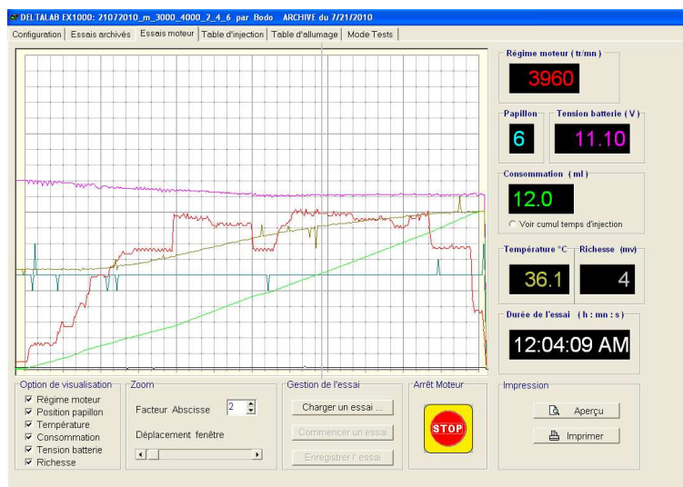
Figura 5 – Modificarea pantei consumului si a vitezei pentru diferite grade de incarcare a motorului
